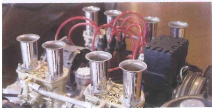
In alto, particolare del propulsore L 240 studiato per l'Urraco. La potenza nella versione di 2,5 litri è di 220 CV (erogati a 7.500 giri/min). Tra le due bancate sono alloggiati ternatore, lo spinterogeno, la pompa dell'acqua e il compressore dell'aria condizionata. A destra, LM 002, fuoristrada con propulsore V 12 prodotto dalla Lamborghini tra il 1986 e il 1992 in 301 esemplari (di cui 157 a iniezione).
