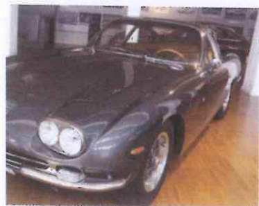
400 GT 2+2, prodotta tra il 1966 e il 1968, un motore di 4 litri. I doppi fari sono necessari per l'omologazione in USA. È stata costruita dalla Carrozzeria Touring in 250 esemplari (cui 23 a due posti).
