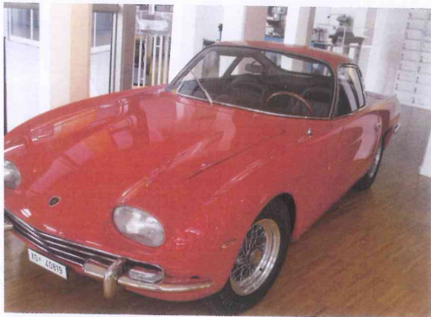
350 GT è stata prodotta tra il 1964 e il 1966. È la prima Lamborghini ad entrare in produzione, rivata dal prototipo 350 GTV (ideato da Franco Scaglione). Il propulsore di questa vettura, progettato dall'ingegner Giotto Bizzarrini, è un 12 cilindri a V di 3,5 litri. La potenza è di 280 CV. La carrozzeria Touring di Milano ha realizzato 120 esemplari di questo modello (più due spyder chiamate 350 GTS).
